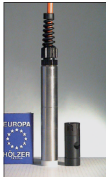
Die ausgezeichnete Innovation: Der kompakt gebaute Sauerstoffsensoren im Kunststoffgehäuse vereint zwei zuvor separate Sonden (Temperaturprofil und Sauerstoff)
